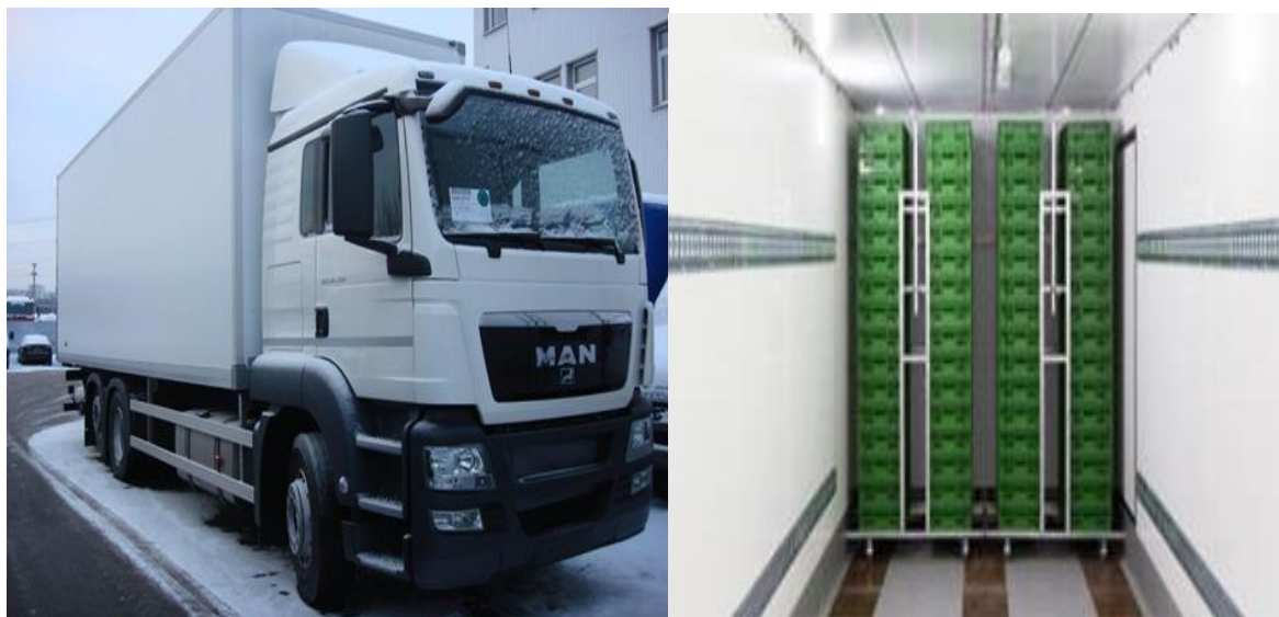
Рис. 2. Транспортное средство с термоизолированным кузовом для перевозки суточных цыплят на базе шасси МАН-TGS 26.320
